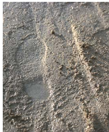
For mindre anlæg accepteres at komprimeringskontrollen baseres på erfaringer for maskinstørrelse, antal passager m.v. suppleret med enkle tests baseret på aftryk fra komprimeringsgrej, hjul m.v. i overfladen. Foto: Torben Dam.
